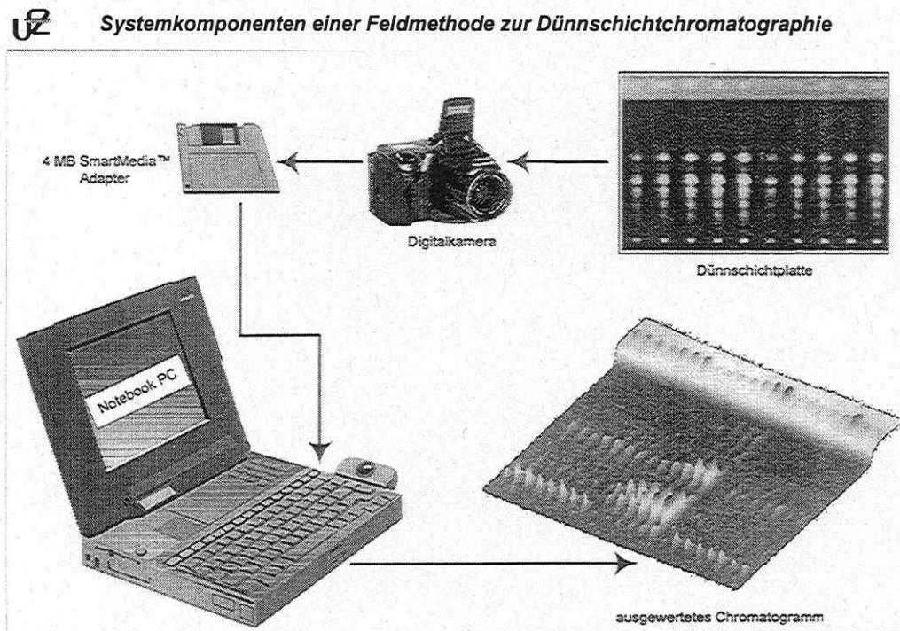
Abbildung 15: Lösungsansatz für eine kostengünstige Visualisierung
