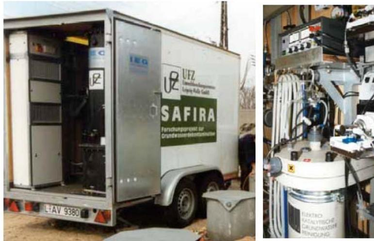
Abbildung 6.1: „Mobile Testeinheit“ und elektrochemisch-katalytischer Reaktor
