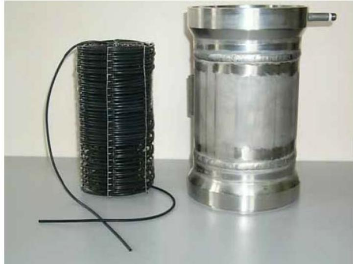
**Abbildung 6.6:** Modularer Reaktor mit Hohlfasermembranmodul in der Tiefbrunnengalerie Bitterfeld
