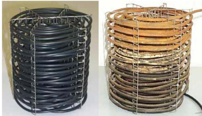
**Abbildung 6.9:** Hohlfaserkatalysator vor und nach dem Feldeinsatz
