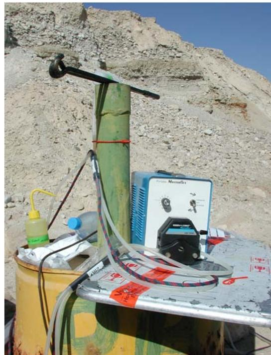
Abb. 2-5: Probenahme an einer Grundwassermessstelle.
