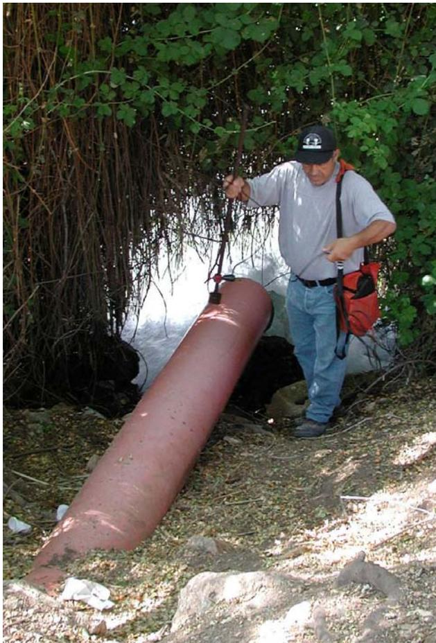
*Abb. B3: Messung des Abflusses an KIN 7 durch einen Mitarbeiter der Meko-rot Co.*
