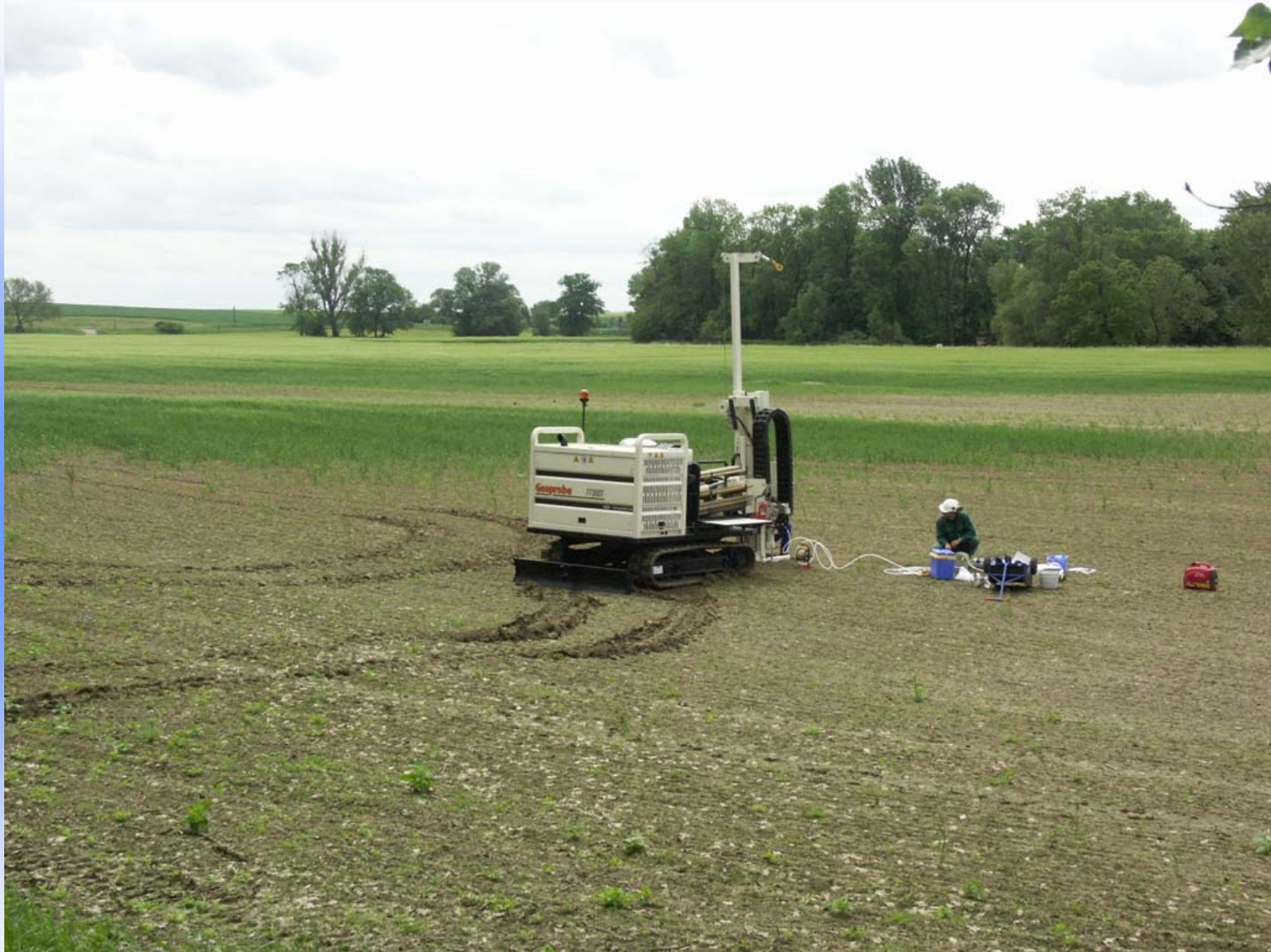
Abteufen der Bohrung mit direct-push Gerät
