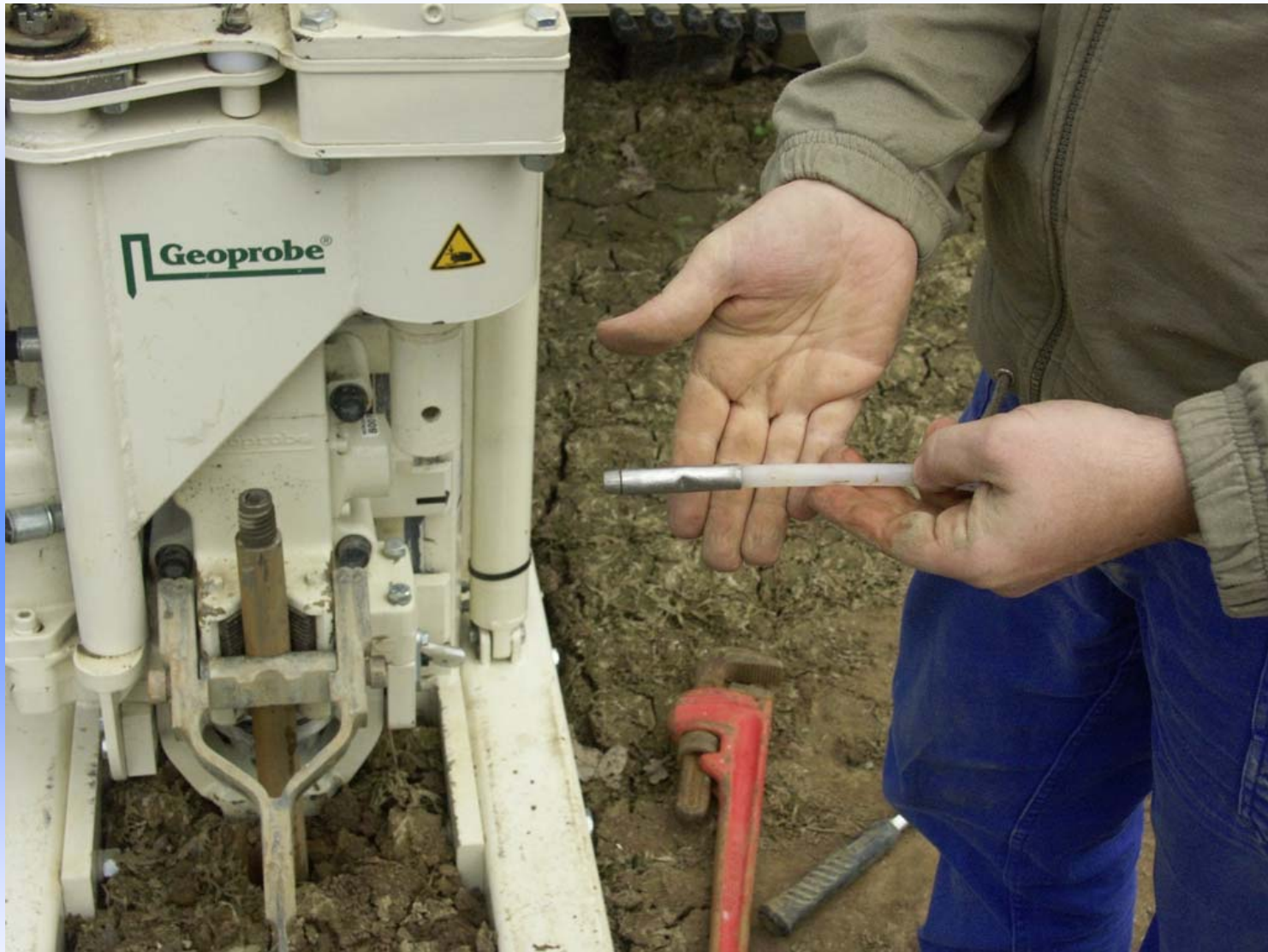
Förderleitung mit Kugelpumpe
