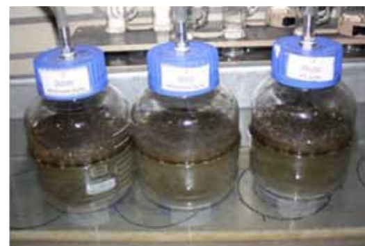
Abbildung 3: Versuch zur Schaumbildung in einer 2-Liter-Versuchsanlage. Die Aufnahmen entstanden 9 h nach Start des Versuches.
