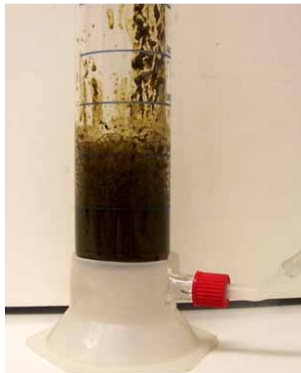
Abbildung 2: Bubble-Test mit Gärmaterial und Eiweißpulver
