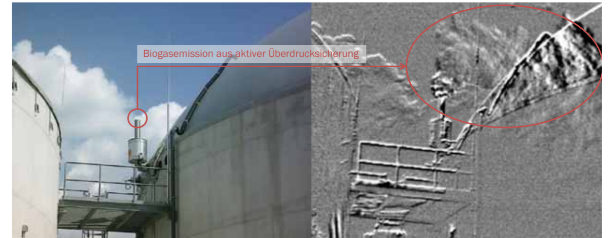
Abbildung 2: Methanemissionen aus einer aktiven Überdrucksicherung an einer Biogasanlage (Foto: Torsten Reinelt, DBFZ) (Quelle: DANIEL-GROMKE et al., 2014)
