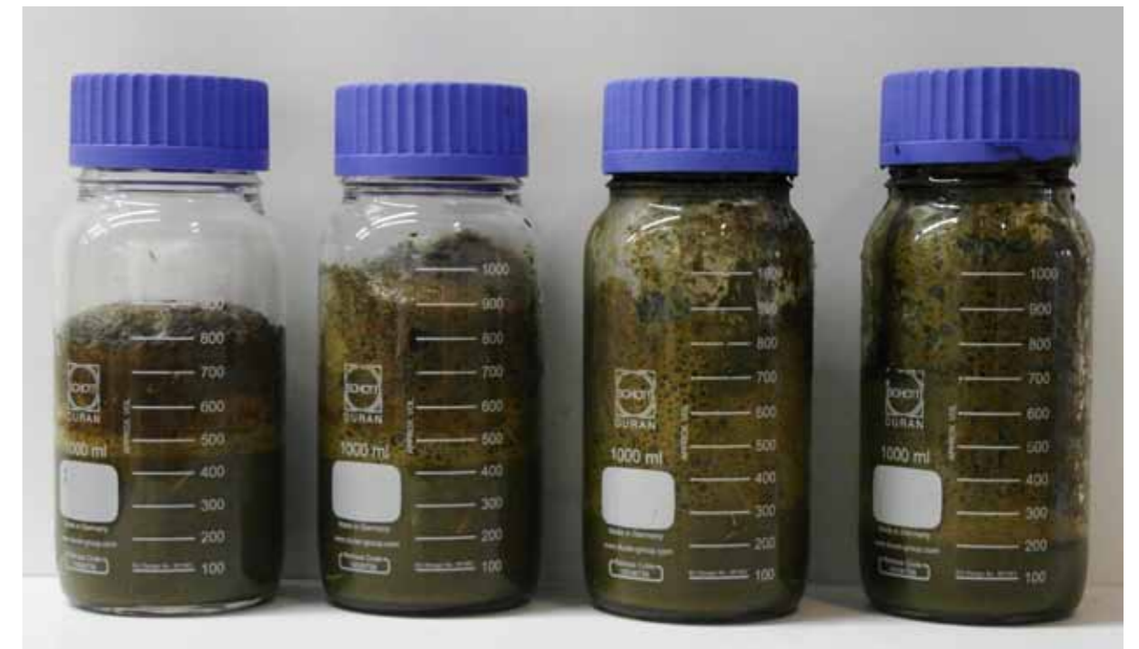
Abbildung 6: Schaumtests mit 40 g unterschiedlich zerkleinerter Zuckerrübe: 1 cm Würfel, 0,5 cm Würfel, gerieben und püriert (von links nach rechts).
