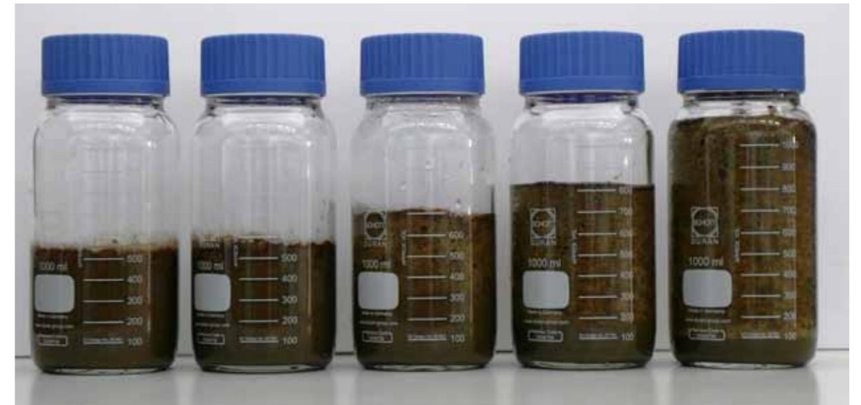
Abbildung 3: Schaumtests mit 0 (Referenz), 10, 25, 50 und 100 g Zuckerrübensilage (von links nach rechts)
