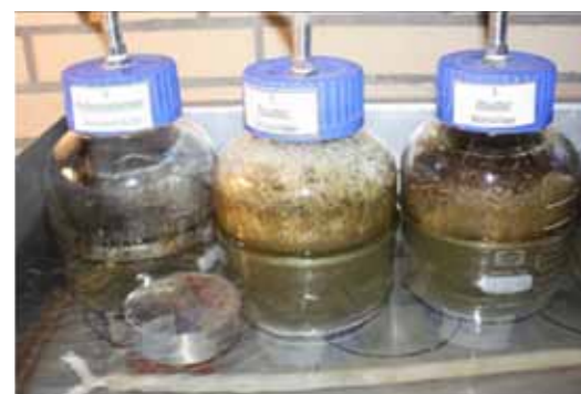
Substrat 1: Fermentersubstrat einer nicht schäumenden Anlage. Diese zeigte auch zu diesem späteren Zeitpunkt keine Reaktion.
