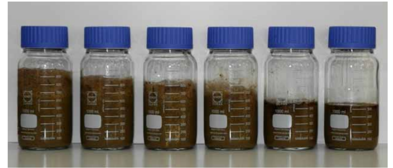
Abbildung 5: Schaumtests mit Triticaleschrot (Mahlstufe: 0,5 mm, 1 mm, 2 mm und 4 mm) und -korn und Referenz ohne Zugabe von Triticale.
