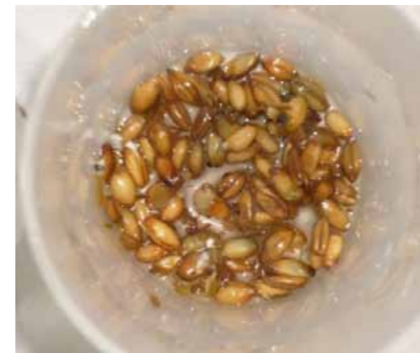
Abbildung 1: Aus dem Gärrest eines Fermenters nach dem Einsatz von unzerkleinertem Roggen ausgewaschene offensichtlich ungenutzte Roggenkörner, Foto: Lars Wolf
