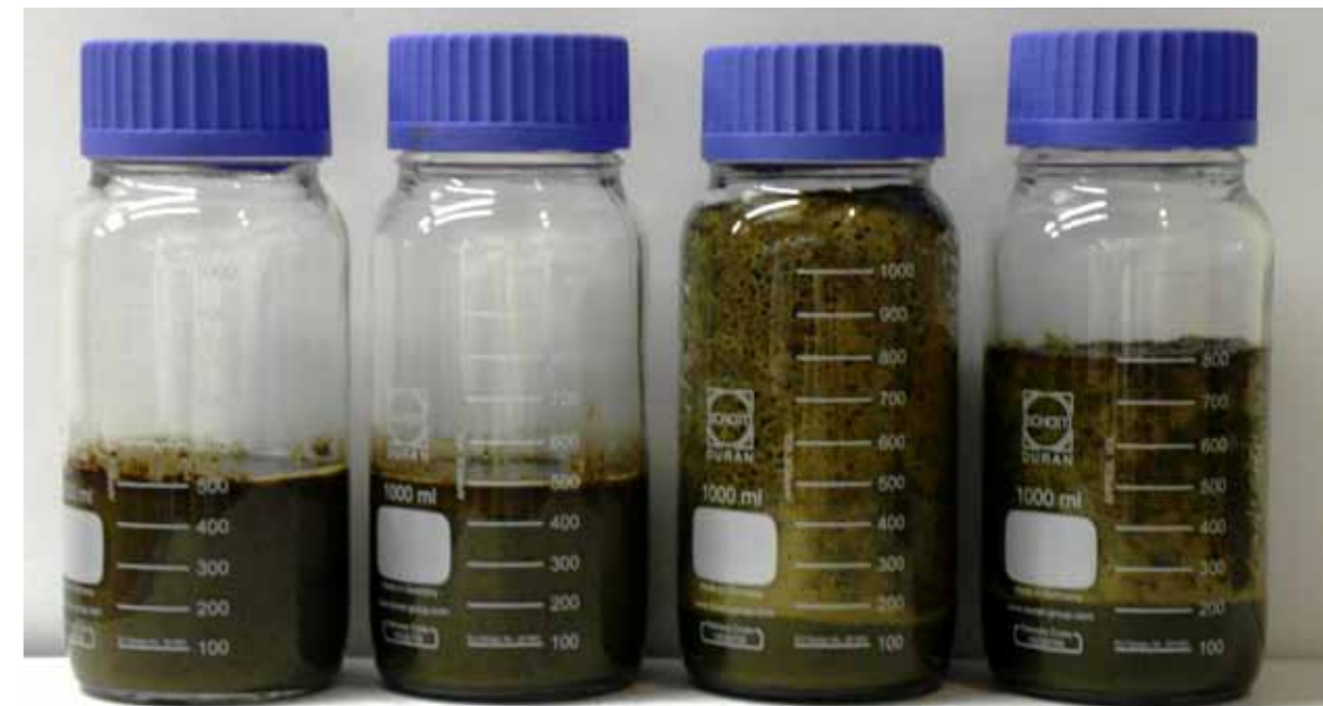
Abbildung 8: Schaumtests zur Ermittlung der Wirkung von Harnstoff auf die Intensität der Schaumbildung bei Vergärung von Zuckerrübe (von links nach rechts: Referenz (ohne Zugabe von Substrat), Zugabe von 5 g Harnstoff, Zugabe von 40 g Zuckerrübensilage, Zugabe von 40 g Zuckerrübensilage und 5 g Harnstoff)
