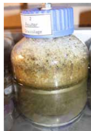
Nahaufnahme des Schaumtests mit Grassilage. Sehr deutlich ist eine Schaumbildung zu erkennen.
