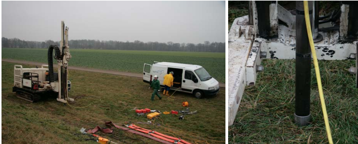
Abb. 2.2-21: Feldmessung ComexHammer in Löbnitz.
