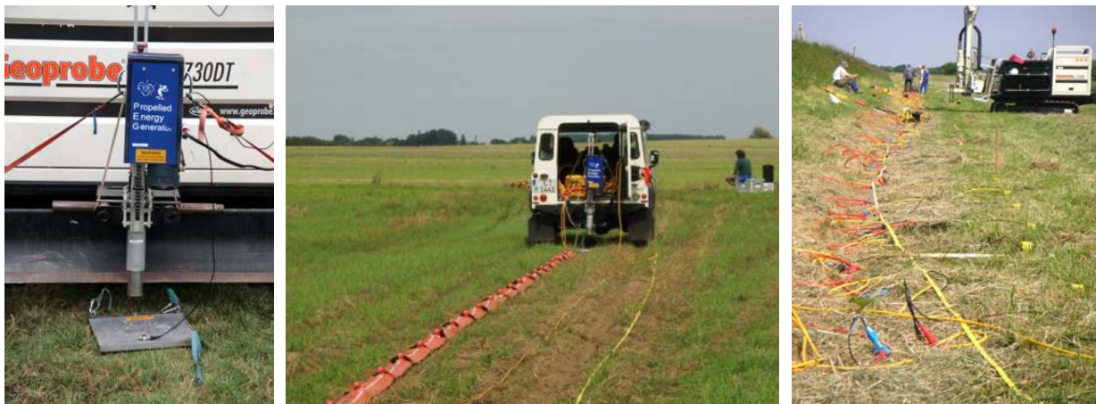
Abb. 2.3-20: Einsatz des beschleunigten Fallgewichts PEG-40, montiert an einem DP-Sondiergerät (links, vgl. auch Abb. 2.3-7) und an einem Landrover Defender (mitte). Die Schlagplatte ist ebenfalls am Fahrzeug befestigt und wird mitgezogen. Rechtes Bild: VSP-Messungen unter Einsatz des Sparkers mit einer festen Geophonauslage.
