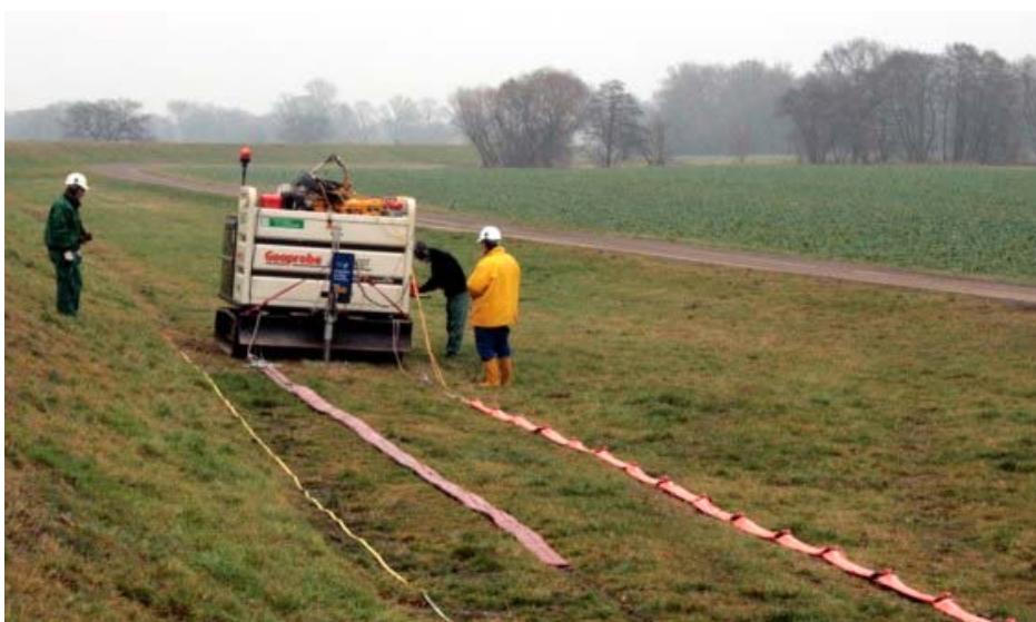
Abb. 2.3-7: Einsatz eines Direct-Push Trailers für seismischen Messungen: links Geotomographie-streamer; rechts UFZ-Landstreamer. Das Fallgewicht PEG-40 ist am Trailer befestigt.
