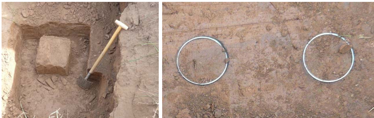
Abb. 2.1-8: Block- und Stutzenentnahme in einem Schurf während der Projektbearbeitung (Standort Löbnitz 2007).
