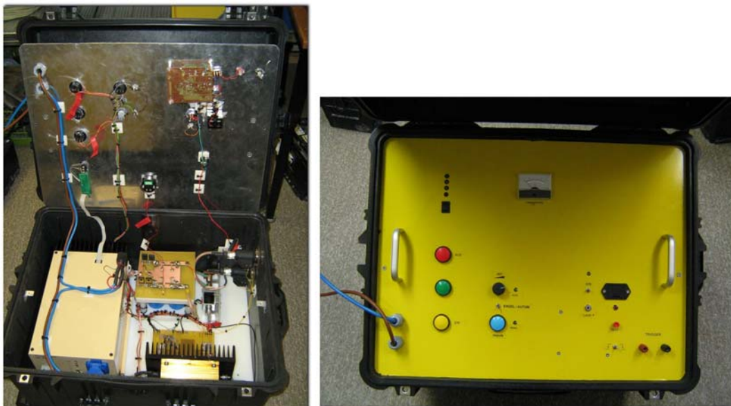
Abb. 2.2-18: 800V Impulsgenerator LV-IPG800V (Bild links: Innenaufbau, Bild rechts Bedienelemente).
