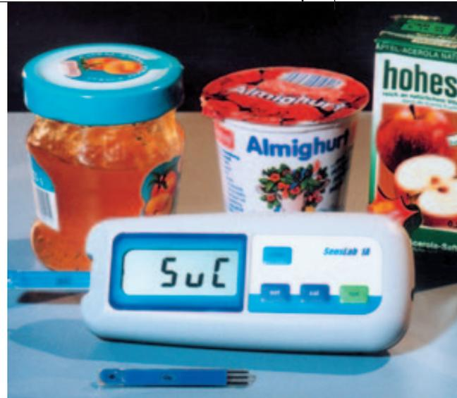
**Multianalyt-Handmessgerät – Der Teststreifen ist nichts anderes als ein Biosensor, entwickelt von der Leipziger Firma Senslab.**
