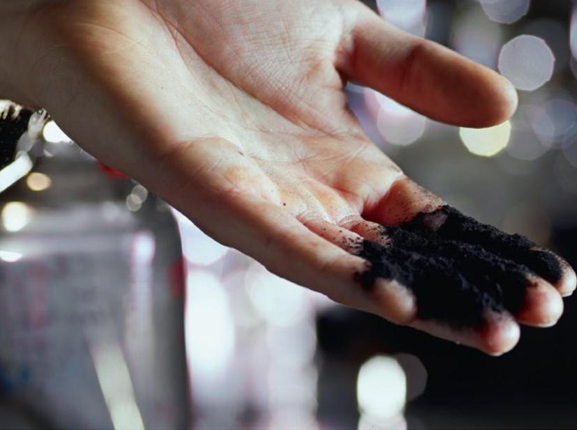
Einsammeln und zerstören – das ist die Aufgabe von Carbo-Iron, einer kohlenstaubfeinen Substanz, die am UFZ entwickelt wurde, um Grundwasser zu reinigen. (Foto: André Künzelmann, UFZ)
