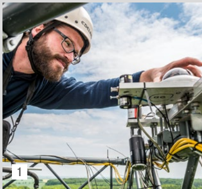
1 Sebastian Gimper in luftiger Höhe beim Justieren eines Pyranometers, mit dem die Sonnenstrahlung erfasst wird.
