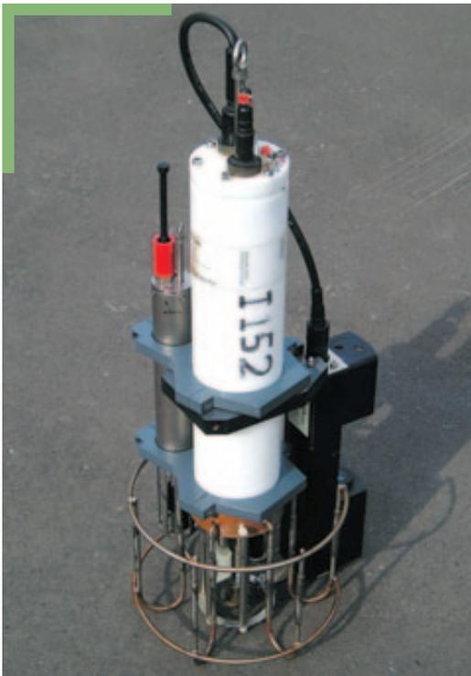
Messsonde zur Untersuchung der Wasserschichtung. Sie ist eine Spezialanfertigung für Seen mit besonders niedrigem oder besonders hohem Salzgehalt. Damit können Temperatur, elektrische Leitfähigkeit, Sauerstoffkonzentration, pH-Wert, Schallgeschwindigkeit, Tiefe und Lichttransmissivität gemessen werden.
