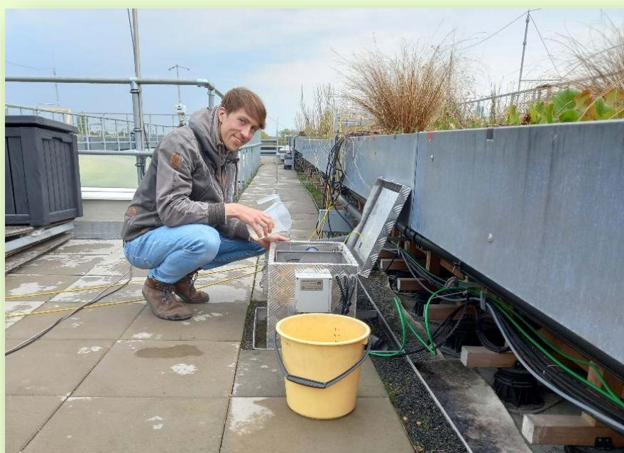
Abbildung 3: Johannes Stüllein bei der Kalibrierung von Dachabflussmessungen
