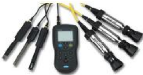
Багатофункціональний вимірювальний пристрій HQ 40 D із зондами для визначення рівня рН, O 2
