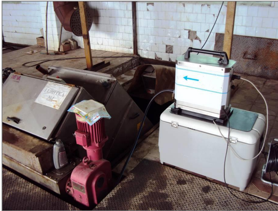
Bühler 1029 mit elektr. Kühlbox Entnahme von 24-h-MP und 2-h-MP
